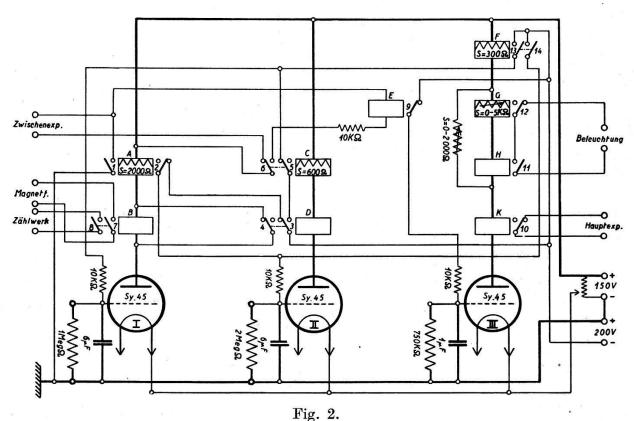
Steuergerät für die automatisch arbeitende Wilsonkammer. (Sämtliche Relais sind in Ruhestellung gezeichnet.)
