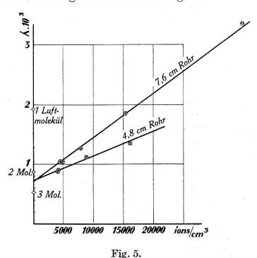
In Fig. 5 ist die Extrapolation auf verschwindende Dichte für zwei Rohrdurchmesser durchgeführt. Der Ordinatenabschnitt der Geraden ergibt den gesuchten Wert. Die Extrapolation auf Rohrdurchmesser null führt innerhalb der Fehlergrenzen auf dasselbe Resultat, nämlich
