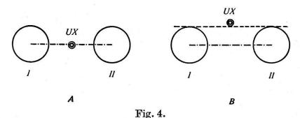
Anordnungen zum Nachweis einer Annihilationsstrahlungs-Komponente durch  $(\gamma, \gamma)$ -Koinzidenzmessungen.
