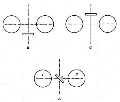
Fig. 12. Anordnungen des Bleiplättchens S zwischen den Zählrohren in Fig. 11.
