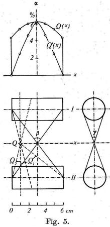
Raumwinkel, aufgespannt von Quelle und Zählrohr.
