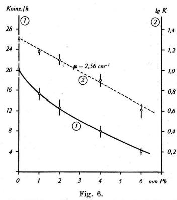
Absorption der UX- $(\gamma, \gamma)$ -Koinzidenzen (bei unbedeckten Zählrohren).
