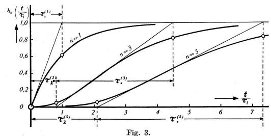
Verschleifung des Einheitsstosses beim Durchgang durch 1, 3 und 5 Verstärkerstufen.
