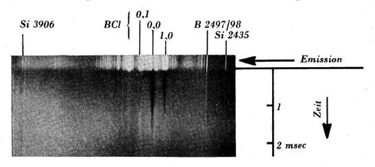
Fig. 6. Emissionsabbruch und Absorptionsspektrum BCl.
