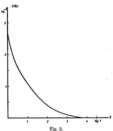
Spektrale Energieverteilung der inneren Bremsstrahlung des  $UX_2$ . (Nach Knipp und Uhlenbeck.)
