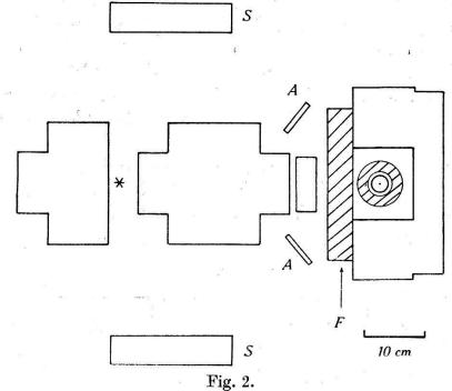
Horizontalschnitt durch die Versuchsanordnung. S sind die Streustrahler, A die Absorber, \* die Quelle. Die nicht schraffierten Teile bestehen aus Blei, die schraffierten aus Messing oder Kupfer.
