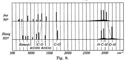
Ultrarotbanden der Glutarsäure HOOC-( $\mathrm{CH_2}$ )<sub>3</sub>-COOH unter- und oberhalb des Schmelzpunktes.
