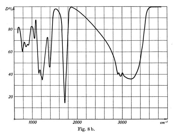
Durchlässigkeit D der Glutarsäure bei  $t=105\,^{\rm o}$  C.
