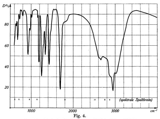
Durchlässigkeit D der Korksäure HOOC-(CH<sub>2</sub>)<sub>6</sub>-COOH als Funktion der Wellenzahlen.
