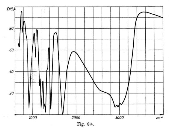
Durchlässigkeit Dder Glutarsäure HOOC–(CH2)3–COOH bei  $t=20\ ^{\rm o}$  C.
