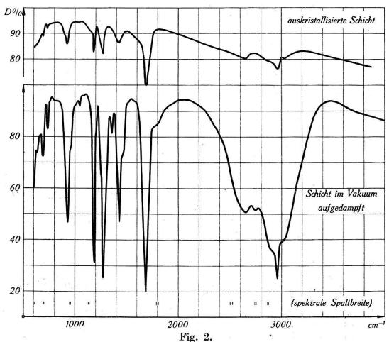
Durchlässigkeit D der Adipinsäure HOOC-(CH<sub>2</sub>)<sub>4</sub>-COOH als Funktion der Wellenzahlen.
