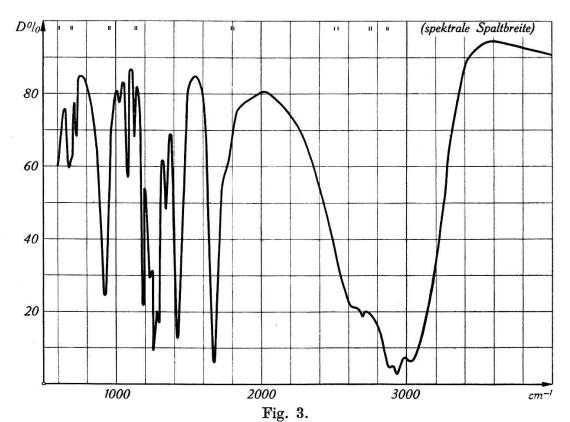
Durchlässigkeit D der Pimelinsäure HOOC–(CH<sub>2</sub>)<sub>5</sub>–COOH als Funktion der Wellenzahlen.
