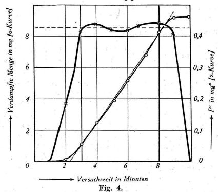
Verdampfungsgeschwindigkeit und Verdampfungsdruck bei einem Versuch an Tellur.
