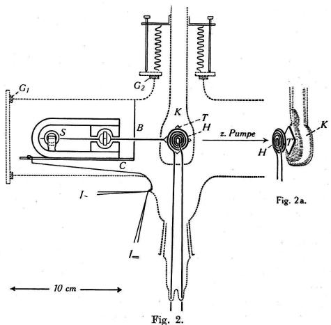
Schema der Apparatur.  $G_1$ ,  $G_2$  = Gummidichtung.
