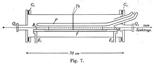
Längsschnitt durch das Absorptionsgefäss.  $G_1$ ,  $G_2 =$  Gummidichtungen.  $Q_1$ ,  $Q_2 =$  Quarzfenster.
