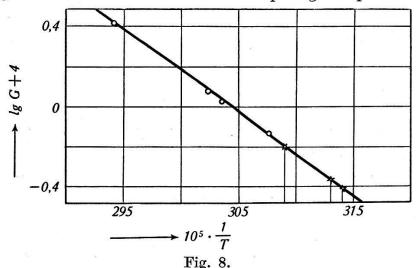
Verdampfungsgeschwindigkeit von HgCl<sub>2</sub> [gcm<sup>-2</sup> sec<sup>-1</sup>].
