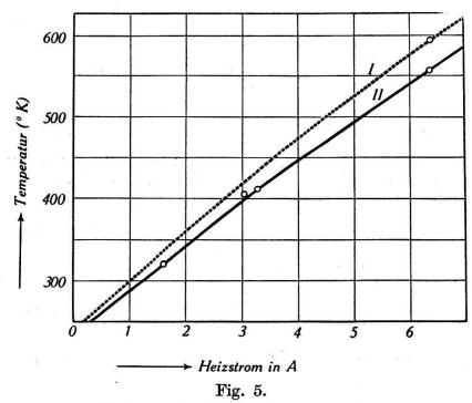
Heizstrom und Plättchentemperatur. Kurve I mit, Kurve II ohne Reflektor hinter der Heizspirale.
