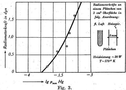
Radiometerkräfte in Abhängigkeit vom Druck.
