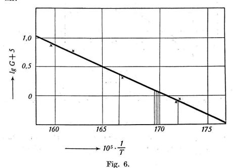
Verdampfungsgeschwindigkeit von Tellur [gcm<sup>-2</sup> sec<sup>-1</sup>].
