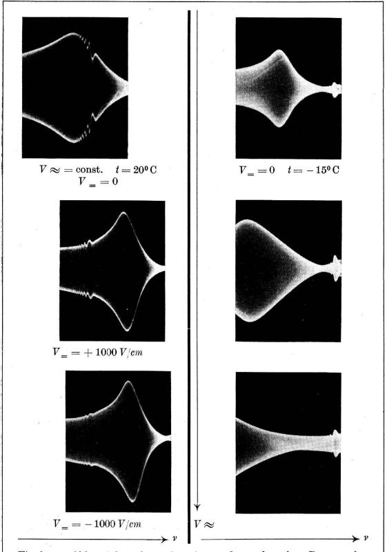
Fig. 9. Abhängigkeit der gedämpften und ungedämpften Resonanzfrequenzen einer Platte, einmal von einem überlagerten Gleichfeld, das andere Mal von wachsender Wechselspannung. Die Resonanzfrequenz bei konstantem Wechselfeld ist ungefähr bei 50 Khz, bei konstantem Gleichfeld bei ungefähr 55 Khz. Für die Aufnahmen in einer Kolonne ist die Abszisse, d. h. die Frequenzskala unverändert.
