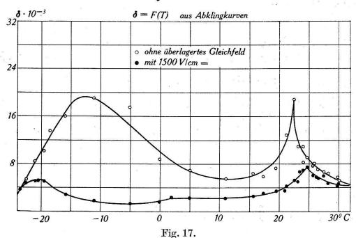
Verlauf der Dämpfungskonstanten im Curiegebiet, aus Abklingkurven gemessen, mit und ohne überlagertes Gleichfeld.
