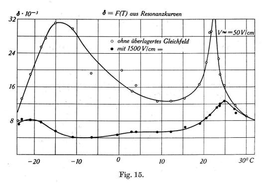
Verlauf der Dämpfungskonstanten im Curiegebiet, aus Halbwertsbreiten der Resonanzkurven gemessen, mit und ohne überlagertes Gleichfeld.
