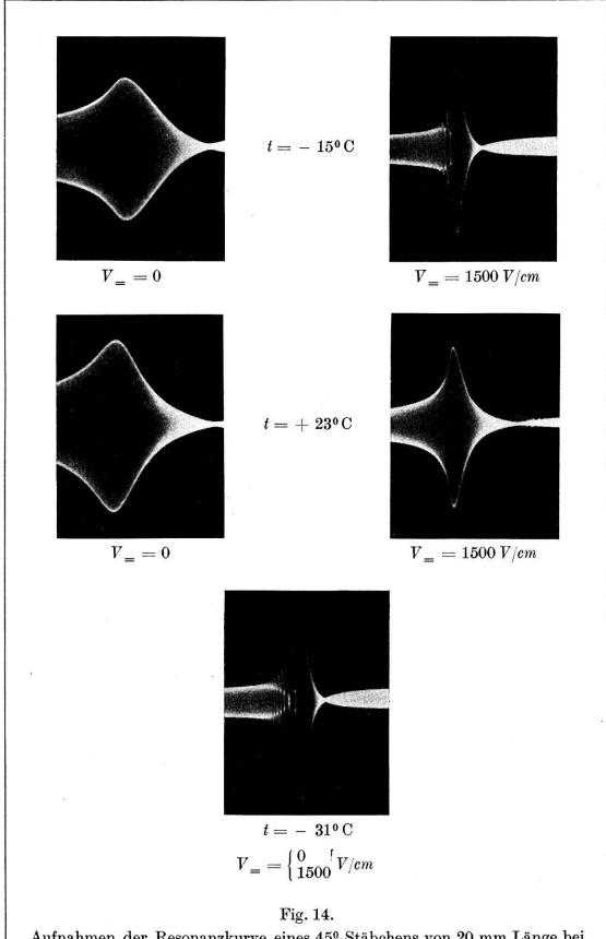
Aufnahmen der Resonanzkurve eines 45°-Stäbehens von 20 mm Länge bei verschiedenen Temperaturen, mit und ohne überlagertes Gleichfeld.
