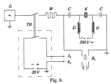
Apparatur zur direkten Bestimmung der Resonanzfrequenz.
