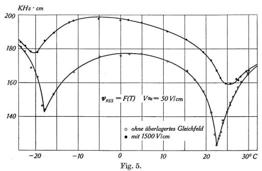
Verlauf der Resonanzfrequenz eines beklebten 45°-Stäbchens im Curiegebiet, mit und ohne überlagertes Gleichfeld.
