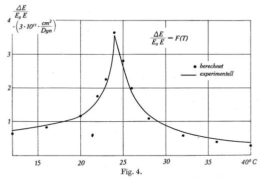
Vergleich der experimentell ermittelten Werte des  $\Delta$  E-Effekts (aus Resonanzfrequenzmessungen von Mason umgerechnet) mit den nach Formel VIII berechneten. (Für die DK wurden die von Mason angegebenen Werte eingesetzt.)
