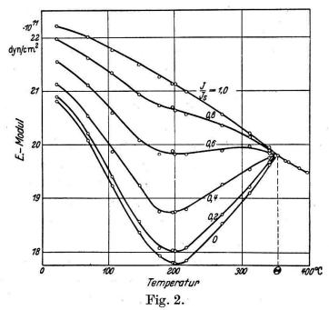
Der Elastizitätsmodul von Nickel in Abhängigkeit von der Temperatur für verschiedene Werte der relativen Sättigung  $J/J_s$ . [Nach S. Siegel u. S. L. Quimby: Phys. Rev. Bd. 49 (1936) S. 663.]
