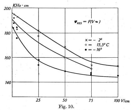
Abhängigkeit der Resonanzfrequenz eines 45°-Stäbchens von wachsender Wechselspannung bei verschiedenen Temperaturen.
