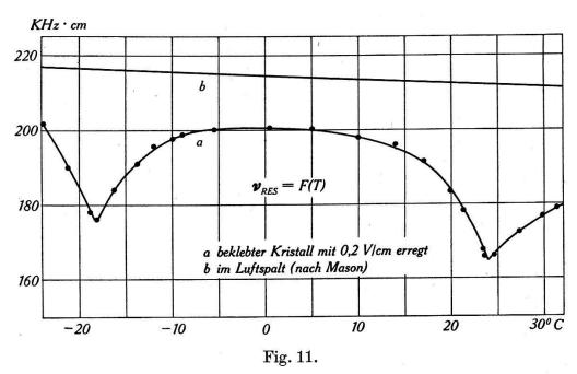
Resonanzfrequenz eines beklebten  $45^{\circ}$ -Stäbchens bei einer maximalen Feldstärke von  $0.2~\mathrm{V/cm}$ .
