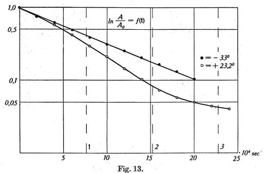
Logarithmisch aufgetragene graphische Auswertung der Abklingkurven eines 45°-Stäbchens von 20 mm Länge, bei Temperaturen innerhalb und ausserhalb des Curiegebiets.
