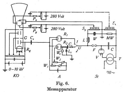
Der Kondensator C des Stosskreises besteht aus 12 Teilkapazitäten zu 0,36  $\mu F$ , welche wahlweise parallel oder in Serie geschaltet werden können, und je eine Spannung von 15 kV halten. Durch den Transformator T wird der Kondensator über die Ventil-
