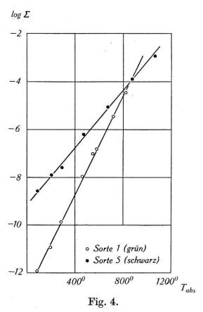
Temperaturabhängigkeit der Leitfähigkeit der Fremdschichten
