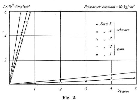
${\rm Pressdruck\;konstant}=10\;{\rm kg/cm^2}.$  Gültigkeit des Ohm'schen Gesetzes für kleine Spannungen.
