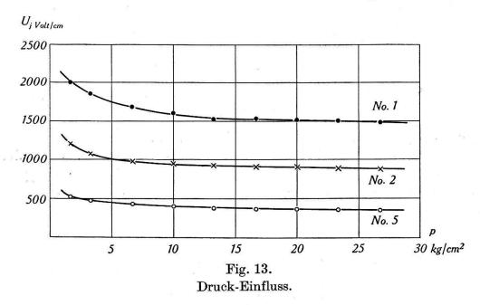
Der Gang von  $\delta_k$  mit dem Pressdruck p ist formal nicht ohne weiteres in einen Zusammenhang zu bringen; wir besitzen aber die Möglichkeit, die Druckabhängigkeit von  $\delta_k$  aus den Kapazitätsmessungen des Abschnittes II/3 zu ermitteln.
