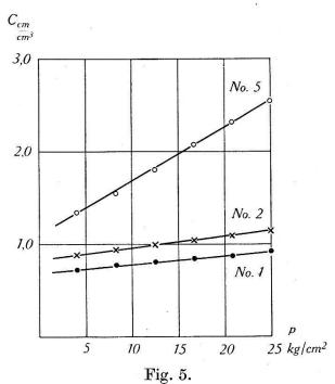
Einfluss des Pressdrucks auf die Kapazität der Kontakte.
