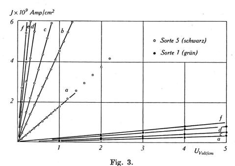
Pressdruck variabel: a:3,3; b:6,6; c:10; d:13,3; e:16,6; f:20 kg/cm<sup>2</sup>. Gültigkeit des Ohm'schen Gesetzes für kleine Spannungen.
