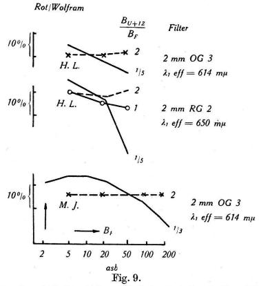
Verringerung der Leuchtdichte-Abhängigkeit im Rot durch U+IZ-Beleuchtung für 2 farbtüchtige Beobachter. Filterlicht, Bechstein-Flimmerphotometer.
