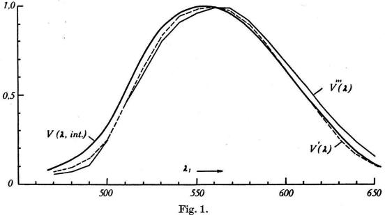
Zusammenstellung einiger  $V(\lambda)$ : Dick ausgezogen:  $V(\lambda, intern.)$ .  $V'(\lambda)$ : Mittelwert für 19 farbnormale Beobachter, Flimmerleuchtdichte 500 asb, Feldgrösse 1,5°, übergossen mit 100 asb weiss.  $V'''(\lambda)$ : entsprechend für 35 asb, übergossen mit 35 asb.
