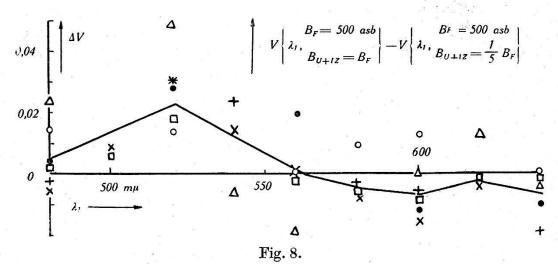
Einfluss von  $B_{U+IZ}$  bei  $B_F=500$  as<br/>b in  $\varDelta V$ -Darstellung. Die ausgezogene Kurve, welche ungefähr den Mittelwert darstellen soll, dividiert durch  $V(\lambda,$  int.), gibt Kurve B in Fig. 6.
