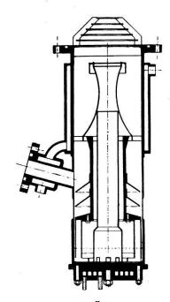
Schema der 200-Liter-Pumpe (Öffnungsdurchmesser 10 cm).
