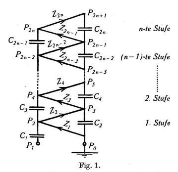
Schaltschema des n-stufigen Kaskadengenerators (nach Greinacher). n = Stufenzahl C = Kondensator Z = Ventil.
