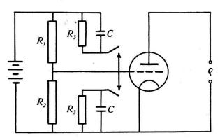
Resistance à caractéristique exponentielle.  $au' = C \cdot \frac{R_1 R_2 + R_2 R_3 + R_3 R_1}{R_1 R_2 R_3}$ .
