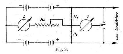
kompensiertem Frequenzgang des Verstärkers ist diese Anzeige proportional zu  $(u_1 - u_2)^2$ , d. h. proportional dem mittleren Quadrat der Differenz der Geschwindigkeitsschwankungen  $u_1$  und  $u_2$  an den beiden Hitzdrähten. Mit K als Eichkonstante des Messverstärkers ist diese Anzeige
