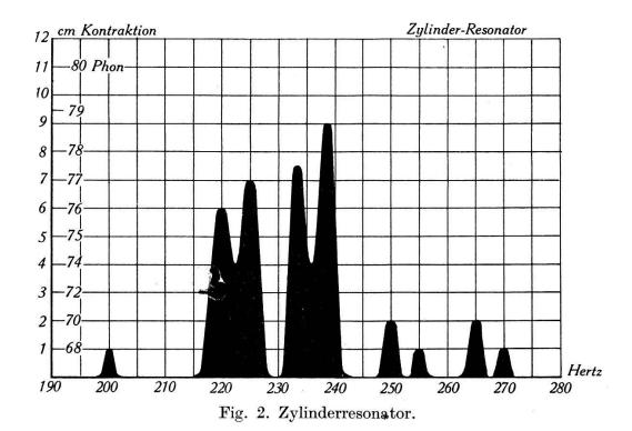
Netzes geeicht, so dass der mittlere Frequenzfehler höchstens  $\pm$  3% betrug. Neben der schallempfindlichen Flamme war ein Massstab aufgestellt, an dem die Kontraktion in cm abgelesen werden konnte.
