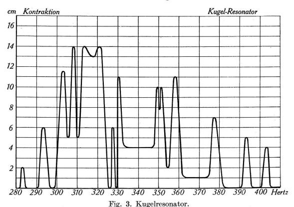
Fig. 3 zeigt nicht weniger denn 14 Resonanzstellen, von denen die Frequenzen 308, 313 und 321 Hertz etwa als Hauptresonanzen angesprochen werden können. Die Verhältnisse sind also viel verwickelter, als man sie sich früher beim Kugelresonator, der doch zu Schallanalysen gebraucht wurde, gedacht hat.
