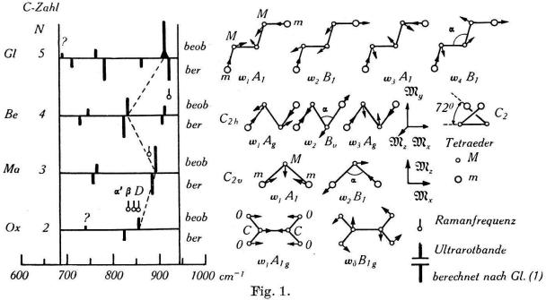
Berechnete und beobachtete Kettenfrequenzen  $\omega_i$  mit ihren Schwingungsformen.  $\alpha'$ =Wasserfreie  $\alpha$ -Form.  $\beta$ =Wasserfreie  $\beta$ -Form. D=Dihydrat.  $C_{2\,h}$ ,  $C_{2\,v}$ ,  $C_2$ =Punktgruppen.  $A_1$ ,  $B_1$ ,  $A_g$ ,  $B_u$ ,  $A_{1\,g}$ ,  $B_{1\,g}$ =Schwingungstypen nach Placzek.  $\mathfrak{M}_x$ ,  $\mathfrak{M}_y$ ,  $\mathfrak{M}_z$ =Momente nach Tabelle 1.
