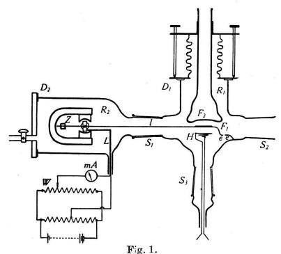
Schema der elektrischen Waage.
