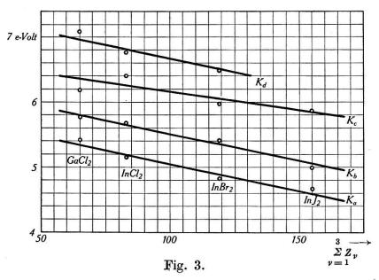
Absorptionsmaxima der Salzdämpfe  $MX_2$  als Funktionen von  $\sum_{\nu=1}^{3} Z_{\nu}$ .  $M = \text{In oder Ga}, \quad X = \text{Cl}, \text{ Br oder J}, \quad Z_{\nu} = \text{Ordnungszahlen der Atome.}$
