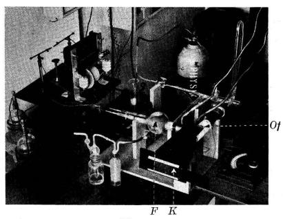
Fig. 6. Vakuum-Fluoreszenz-Apparatur mit Kamera (c).  $F = \text{Funke}, \ Of = \text{Ofen}, \ K = \text{Kamera}.$
