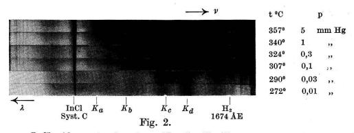
InCl<sub>2</sub> Absorptionskontinua  $K_a$ ,  $K_b$ ,  $K_c$ ,  $K_d$ .
