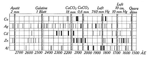
Fig. 7. Funkenspektren und Filter.
