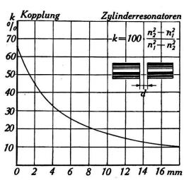
Im Anschluss an diese Beobachtungen möge noch ein neuer akustischer Kopplungsversuch beschrieben werden, der sich für Vorlesungs- und Praktikumszwecke gut eignet. In das Schallfeld eines grossen Lautsprechers, der von einem Schwebungstongenerator mit Tonfrequenzen zwischen 0 und 10000 Hertz erregt werden kann, bringt man zwei koaxial aufgestellte kleine Zylinderresonatoren von beispielsweise 75 cm³ Inhalt. Ihre Endflächen weisen zentrale kreisförmige Löcher auf, die gegeneinander im Abstande
