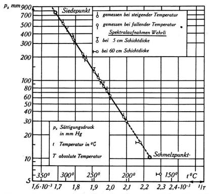
Dampfdruck von Tellurdichlorid in halblogarithmischer Darstellung.
