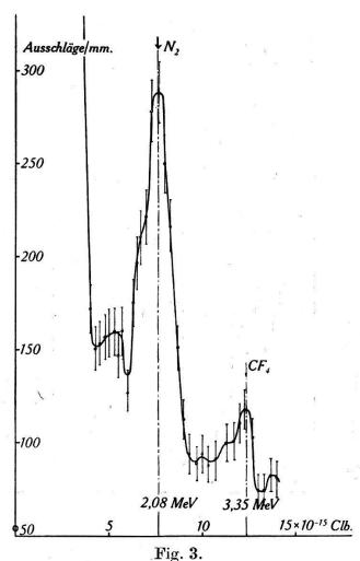
Energiemessung mit Hilfe der  $N(n, \alpha)B$ -Reaktion.
