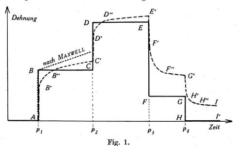
Verhalten des Biegungspfeiles im Linsenmembran-Zentrum. ABCD...: Idealelastisches Material bei verschiedener Belastung p. A'B'B''C'...: bei Kunststoffen. Es bedeuten dabei A'B' bzw. E'F' die "momentan" verlaufende Dehnung,
