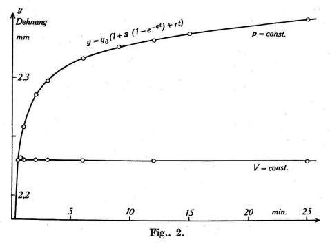
Typus des Verhaltens bei konstantem Druck p und bei konstantem Füllungsvolumen V. Experimentelle Werte, gemessen an einer 0,5 mm dicken Melopasplatte. Die V= konst.-Kurve ist, aus Gründen der besseren Darstellung des typischen Unterschiedes im Verhalten, parallel zu sich verschoben an die Momentandehnung der p= konst.-Kurve angeschlossen.
