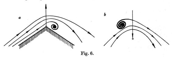
keilförmigen Hindernisses Wirbelablösung in der oben dargestellten Weise. Fig. 6a. Hier liegt eine Strömung vor, deren Geschwindigkeit nach aussen, in Richtung der positiven y-Achse zunimmt. Zum Vergleiche haben wir in Fig. 6b eine Umkehrstelle
