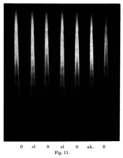
Fig. 11 gibt einen direkten Vergleich zwischen Schallbeeinflussung unter 297 Hertz (rechts) und elektrischer Erregung mit 210 Volt eff. bei derselben Frequenz unter Einführung von Kaliumionen. Zwischen Schall- und elektrischer Erregung ist kein Unterschied erkennbar. Die Aufnahmen zeigen die Flammenbreitseite. Unbeeinflusste und erregte Flammen wechseln miteinander ab.
