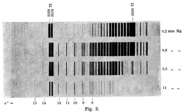
U.V.-System von TlCl (Prismenspektrogramm). Aufnahmen bei verschiedenen Drucken. Die Serie v'=5 ist mit der Quantenzahl v'' markiert.
