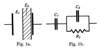
Das Ersatzschema dieser Anordnung zeigt Fig. 1b, die Spannung verteilt sich auf die beiden Teile im Verhältnis der Impedanzen. Es ist
