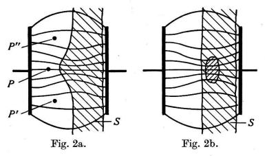
Besteht das zu behandelnde Medium aus mehreren Schichten, so werden die Verhältnisse komplizierter. Für den praktischen Fall ist aber der schichtweise Aufbau normalerweise immer hinreichend ähnlich, sodass die Auswertung einer Messung im Aussenraum mit Hilfe empirischer Tabellen vorgenommen werden kann.
