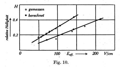
Die berechneten Punkte liegen mit befriedigender Genauigkeit auf der experimentell aufgenommenen Kurve. Man sieht, dass die Eichkurve für Wechselstrombetrieb wesentlich flacher verläuft, als die für Gleichstrom. Selbst unter der Annahme, dass  $E_{\mathbf{Z}}$  und  $E_{\mathbf{L}}$  Null sind, dass also die Lichtemission der Indikatorkugel schon bei kleinen Feldstärken einsetzt, ist die Wechselstromkurve flacher. Es ist in diesem Falle der Tangens des Neigungswinkels der Eichkurve
