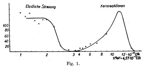
Elastische Streuung und Kernreaktionen von schnellen Neutronen an Stickstoff. Abszisse: Energie der registrierten Teilchen. Ordinate: Zahl der Ausschläge am Oszillographen.
