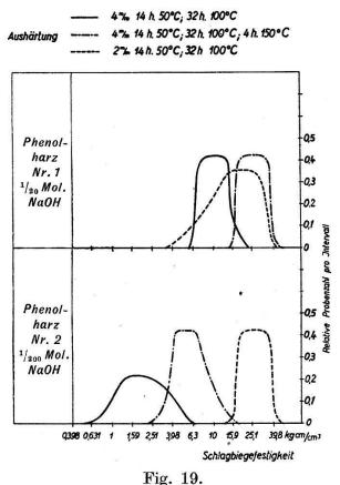
Häufigkeitskurven für die Schlagbiegefestigkeit von Versuchsharz Nr. 1 und 2, bestimmt mit Dynstat.
