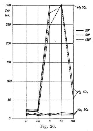
Einfluss der Temperatur auf die Kriechwegbildung bei den Elektrolyten Na<sub>2</sub>SO<sub>4</sub> und MgSO<sub>4</sub>.
