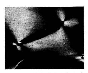
Fig. 10. Einschlüsse in Phenolharzen in polarisiertem Licht ( $\times$  180).
