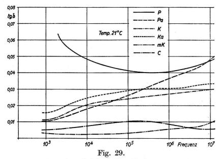
Zusammenhang zwischen den dielektrischen Verlusten von Phenolharzen (mit üblichem Gehalt an Kondensationsmittel und ausgewaschen) und Metakresolharz (chemisch umgebaut) und der Frequenz, bei 20° C.
