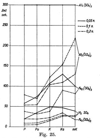
Kriechwegbildung in Abhängigkeit von der Konzentration der Elektrolyten  $Al_2(SO_4)_3$  und  $Fe_2(SO_4)_3$ .
