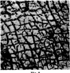
Fig. 2. Gefüge von Kresolharz in durchfallendem Licht, kapillare Korngrenzen ( $\times$  300).
