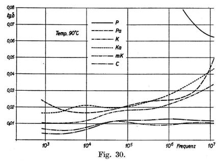
Zusammenhang zwischen den dielektrischen Verlusten der Prüflinge wie in Fig. 29 und der Frequenz, bei 90°.
