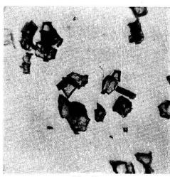
Fig. 17. Bruchstücke aus gequollenem Phenolharz, Versuchsharz Nr. 2, in dünnen Probeplatten gehärtet ( $\times$  8).
