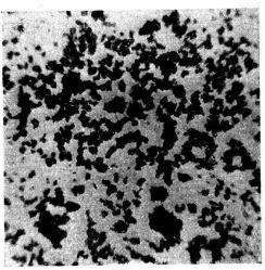
Fig. 16. Bruchstücke gequollener Kresolharze, Versuchsharz Nr. 2, dicke Probeplatten  $(\times 8)$ .
