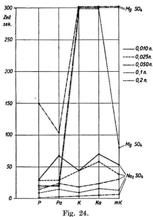
Kriechwegbildung in Abhängigkeit von der Konzentration der Elektrolyte Na<sub>2</sub>SO<sub>4</sub> und MgSO<sub>4</sub>.
