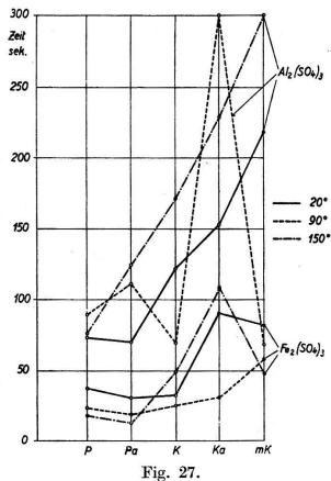
Einfluss der Temperatur auf die Kriechwegbildung bei den Elektrolyten Al<sub>2</sub>(SO<sub>4</sub>)<sub>3</sub> und Fe<sub>2</sub> (SO<sub>4</sub>)<sub>3</sub>.
