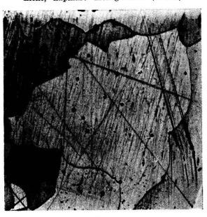
Fig. 4. Gleicher Flusstahl wie Fig. 3 nach entsprechender Glühbehandlung. Korngrenzen infolge der Grenzflächenkräfte zum Teil hyperbolisch. Beispiel für kapillare Korngrenzen ( $\times 150$ ).
