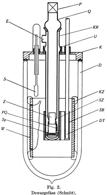
Fig. 2 zeigt einen Schnitt durch das Dewar-Gefäss. Die Messingkappe K schliesst das Dewargefäss D oben vakuumdicht ab. Die Dichtung erfolgt durch Apiezonwachs, das in eine Nut von K, die der Form des Randes des Dewargefässes angepasst war, eingestrichen wurde. Wird das Dewargefäss nur leicht an K
