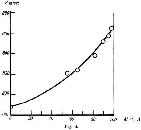
Schallgeschwindigkeit in verflüssigten A— $N_2$  Gemischen bei —190  $^{\rm o}$  C als Funktion des Argongehaltes der Flüssigkeit.
