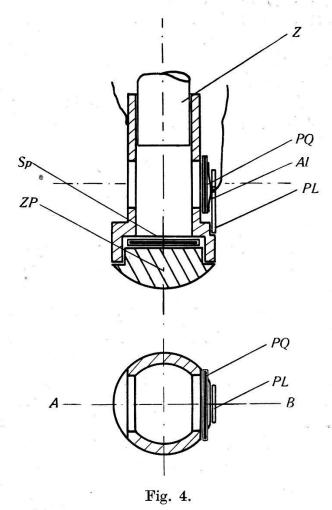
Halterung des Piezoquarzes (Schnitt).
