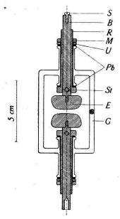
Fig. 1. Elektrodenhalterung.
