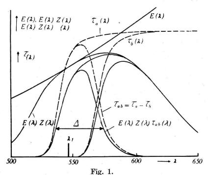
Ausfiltern des die Linie  $\lambda_1$  umgebenden Bereiches  $\Delta$  aus der Strahlung  $E(\lambda)$  mittelst der Empfindlichkeitsfunktion  $Z(\lambda)$  und dem (reduziert dargestellten) Differenzfilter  $\tau_{ab}(\lambda) = \tau_a(\lambda) - \tau_b(\lambda)$ .
