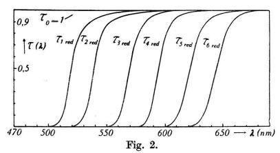
Gelb-Rot-Filterserie von Schott; reduzierte spektrale Durchlässigkeiten  $\tau_{i \text{ red}}(\lambda)$  (ohne Reflexionsverlust).
