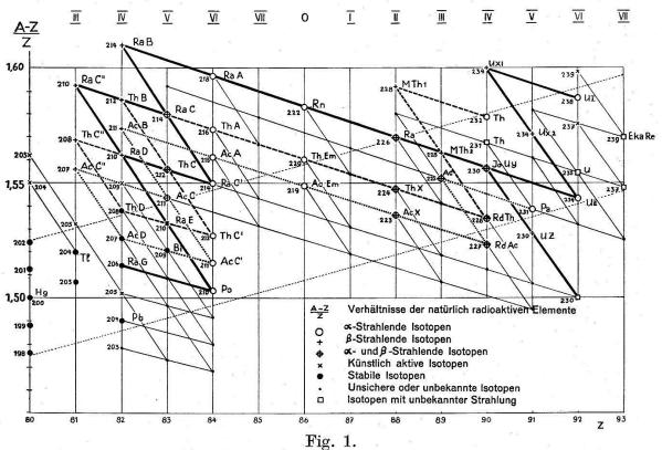
Darstellung des Neutronen-Protonen-Verhältnisses der natürlich radioaktiven Elemente in Abhängigkeit von der Ordnungszahl. Verlauf der Zerfallsreihen von Uran (ausgezogen) Thorium (gestrichelt) und Actinium (punktiert). Einzeichnung einiger hypothetischer Zerfallsvorgänge (feine Linien) und Zerfallsreihen. Zahlen links neben den Isotopen = Atomgewichte.
