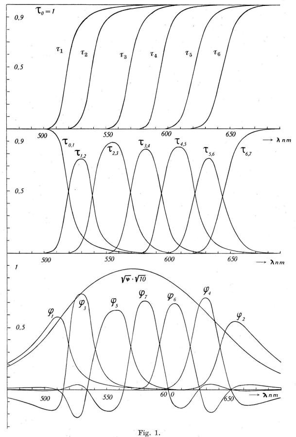
Zerlegung des Spektrums für die Hellempfindlichkeits-Bestimmung.
