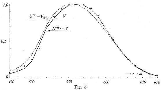
Annäherung der gemessenen Funktion V durch  $V'=U^{(\infty)}$ , ausgehend von  $U^{(0)}=V_{\rm int}$ , mittelst sukzessiver Approximation.
