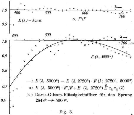
Optimale Angleichungen mittelst Kombinations-Blaufilter  $F'(\lambda) = \sum_{k=1}^{K} x_k \tau_k(\lambda)$ . Oben: Annäherung des energiegleichen Spektrums,
