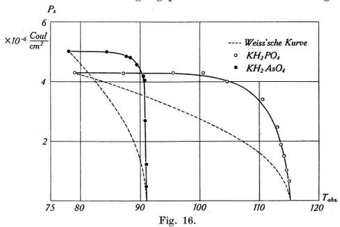
Temperaturabhängigkeit der Sättigungs-Polarisation.
