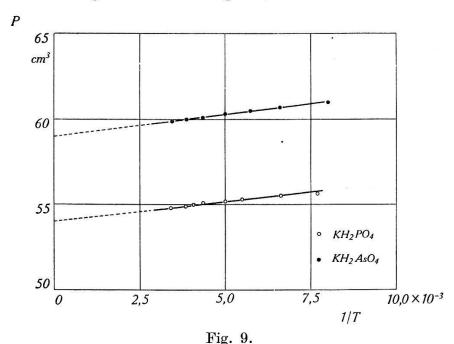
Molekular polarisation als Funktion von 1/T. a-Achse.
