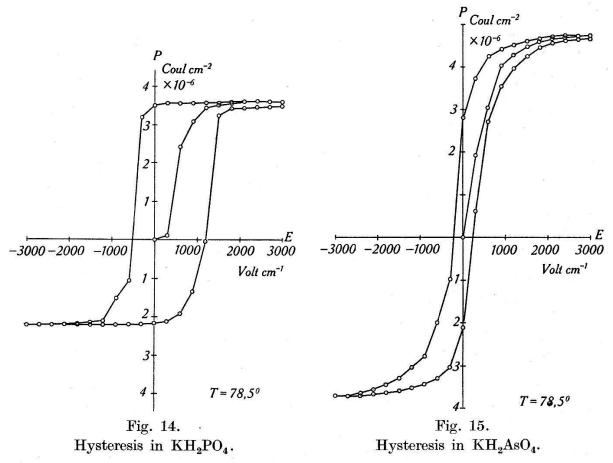
Werte übersteigen die am Seignette-Salz gemessenen um fast das 25-fache. Mit steigender Temperatur werden die Hysteresis-Schleifen immer schmaler und verschwinden am Curie-Punkt vollständig; ebenso verschwindet die Asymmetrie der Hysteresis-Kurven in bezug auf den Nullpunkt allmählich. Die a-Achse der Kristalle zeigt keine Hysteresis.
