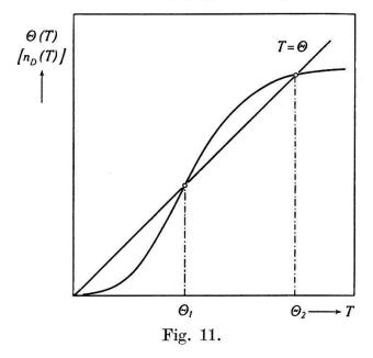
Temperaturen vorhandenen Dipolzahlen eingesetzt werden. Im Anschluss an Müller<sup>8</sup>) kann man jedoch die Curie-Temperatur als eine Funktion  $\Theta(T)$  der Temperatur auffassen und  $n_{\rm D}(T)$  als Temperaturfunktion bestehen lassen, so dass an Stelle von (5) die Gleichung tritt:
