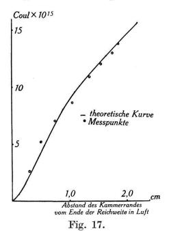
Seitwärtsstrahlung von Po-a-Teilchen in die Ionisationskammer.
