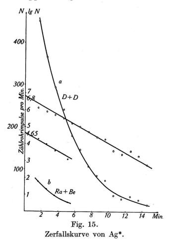
hernach die Abklingungskurve des 2,3 Min.-Körpers gemessen (Fig. 15). Bei derselben geometrischen Anordnung bestrahlte man das Ag-Blech mit den Neutronen von 55,3 mg (Ra + Be) und bestimmte wiederum die Zerfallskurve des 2,3 Min.-Körpers (Fig. 15). Die Anfangswerte der Aktivitäten betrugen mit der Zertrümmerungsapparatur 90/sec, mit der (Ra + Be)-Quelle 11/sec. Die Hochspannungsapparatur ist daher ungefähr 0,5 gr (Ra + Be) äquivalent.
