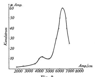
Fig. 3. Magnetisches Spektrum des D-Kanalstrahles.
