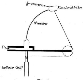
Fig. 1. Nachströmungsventil.
