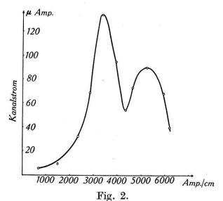
Magnetisches Spektrum des H-Kanalstrahles.
