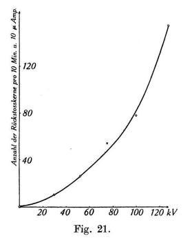
Spannungsabhängigkeit der Neutronenintensität.
