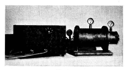
Fig. 10. Linearer Verstärker und Ionisationskammer.
