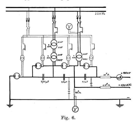
Schaltschema der Hochspannungsanlage.
