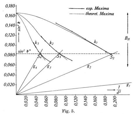
Maxima der Durchlässigkeit für die Ultraschallfrequenz 2,007 · 10<sup>6</sup> Hz; [Xylol; Glaskeil II].
