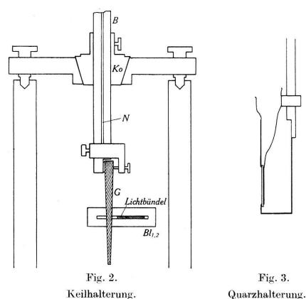
Marke (feine Rinne) am Bolzen anvisiert, und zwar einmal, wenn der Keil sich in der Durchstrahlungsstellung befand, und ein zweites Mal, wenn die Schneide des Keils in der Mitte der Öffnungen der Blenden  $Bl_1$  and  $Bl_2$  stand (Nullstellung!). Da die Dicke aller verwendeten Keile mit der Höhe genau linear zunahm, konnte hieraus die Keildicke an der durchstrahlten Stelle berechnet werden.
