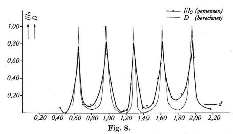
Durchlässigkeit D und  $I/I_0$  als Funktion von d beim Einfallswinkel  $\vartheta=11^{\circ}\,00'$  [7,55  $\cdot\,10^{\circ}$  Hz, Glaskeil in Wasser].
