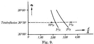
Kurven konstanter Schalldurchlässigkeit beim Grenzwinkel der Totalreflexion der Rotationswellen [Glaskeil in Wasser].
