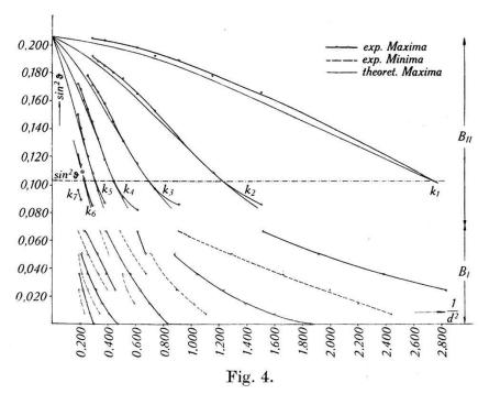
Maxima und Minima der Durchlässigkeit für die Ultraschallfrequenz 7,55 · 10<sup>6</sup> Hz; [Wasser, Glaskeil I].
