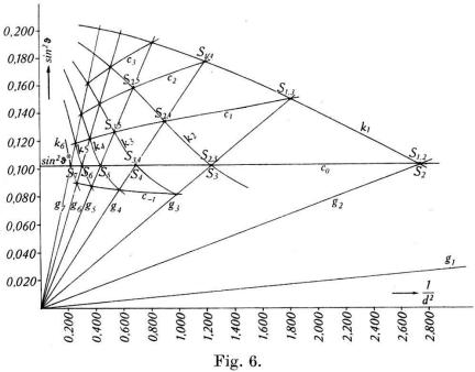
Graphische Bestimmung der Rotationsgeschwindigkeit und der zu den Kurven  $k_m$  gehörenden ganzen Zahlen n nach der 1. Methode.
