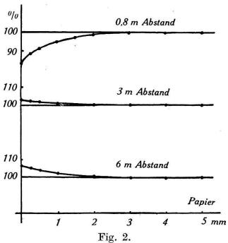
Änderung des Ionisationsstromes mit variabler Kammerwanddicke für verschiedene Abstände zwischen Kammer und Präparat. Filter 7 mm Pb. Hochschule für Leibesübungen.
