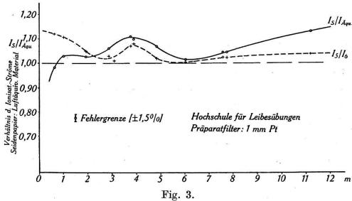
Verhältnis des Ionisationsstromes der Seidenpapierkammer zu dem der luftäquivalenten Kammer  $(I_S/I_{\rm Äqu})$  für eine Präparatfilterung von 1 mm Pt. Das Verhältnis der mit fünf Wänden (Vorderwand frei) umkleideten Kammer zu der mit 6 Wänden  $(I_5/I_6)$  ist gestrichelt eingezeichnet. Hochschule für Leibesübungen.
