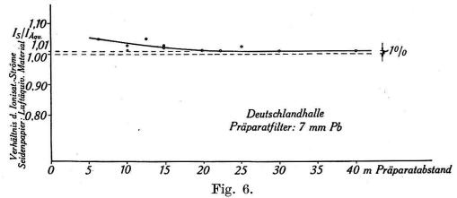
Verhältnis des Ionisationsstromes der Seidenpapierkammer zu dem der luftäquivalenten Kammer ( $I_S/I_{\rm Aqu}$ ) für eine Präparatfilterung von 7 mm Pb. Deutschlandhalle.
