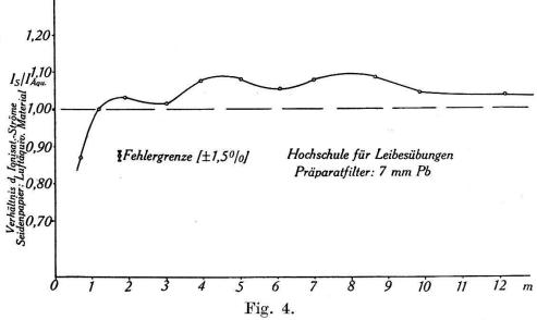
Verhältnis des Ionisationsstromes der Seidenpapierkammer zu dem der luftäquivalenten Kammer ( $I_S/I_{\rm Äqu.}$ ) für eine Präparatfilterung von 7 mm Pb. Hochschule für Leibesübungen.
