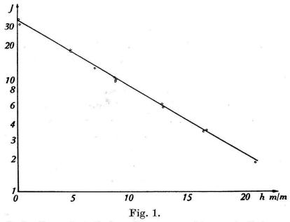
Abhängigkeit der Intensität J eines Beugungsspektrums 1. Ordnung als Funktion des Abstandes h von der Eintrittsstelle der Schallwellen in den Flüssigkeitstrog für Wasser bei 53,7 Megahertz (halblogarithmische Dastellung).
