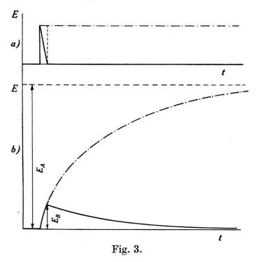
Zwischen dem Punkte A und Erde entsteht während eines einmaligen Kippens ein Spannungsstoss von der Form der voll ausgezogenen Linie in Fig. 3a. Vor dem Kippen ist die Spannung am Punkte A gegen Erde angenähert gleich Null. Infolge der Entladung des Kondensators  $C_1$  wächst die Spannung praktisch momentan bis fast 280 Volt an, um nachher während des Aufladevorganges linear bis auf den früheren Wert wieder abzunehmen. Dieser Spannungsstoss wird mittelst des Widerstandes  $R_4$  und
