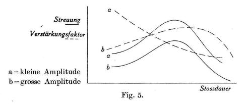
Stössen und der Verstärkungsfaktor des Verstärkers. Der Verstärkungsfaktor konnte geändert werden durch Änderung des Heizstromes der einzelnen Röhren, hauptsächlich der stark unterheizten Eingangsröhre, sowie durch Änderung der Gittervorspannungen. Der Verstärkungsfaktor war auch von der Dauer und Amplitude der Stösse abhängig. Aufnahme b) der Tafel zeigt eine Probe aus den Prüfaufnahmen.
