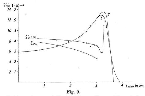
Ionisierungskurve und Streuungskurve. Kammerfüllung Luft.
