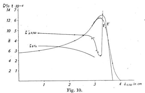
Ionisierungskurve und Streuungskurve. Kammerfüllung Stickstoff.
