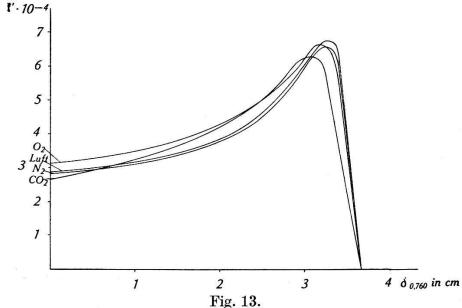
Ionisierungskurven auf gleiche Reichweite  $R_0=3,67$  cm reduziert.
