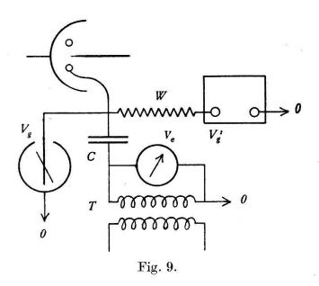
letztere durch Einschalten eines Telephons konstatiert. Um einen Vergleich bei verschiedenen Frequenzen zu ermöglichen, wurden die Wechselspannungen stets auf denselben Wert (220 Volt) einreguliert, was am statischen Voltmeter  $V_e$  kontrolliert wurde. Es ergaben sich folgende Resultate:
