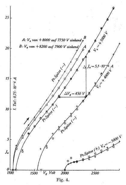
chend  $R=1/DS=3\cdot 10^5$  Ohm. Beachtenswert ist der Umstand, dass auch mit höheren Spannungen (ca. 8000 Volt) Kurven mit ungefähr gleicher Steilheit und zudem nur wenig höheren Stromwerten erhalten wurden.
