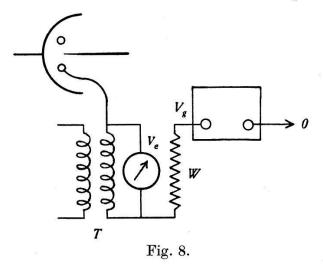
Ein in den Spitzenstrom eingeschaltetes Telephon zeigte andererseits ausser dem leisen Spitzenrauschen auch vernehmlich den Wechselstrombrummton, der übrigens subjektiv bei  $V_g=1500$  und  $V_g=2400$  V nicht merkbar verschieden laut war. Das heisst, die Wechselstromverstärkung hing entsprechend der geraden Charakteristik nicht vom Arbeitspunkt ab.
