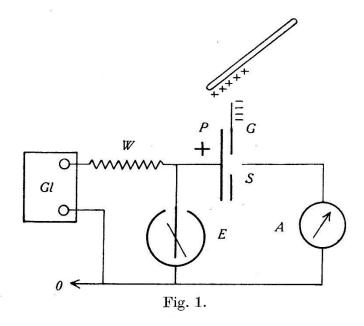
P eine Spannung von +5000 V angelegt, so erhielt man einen Spitzenstrom von 5—6 Teilen. Wurden aber P und G vorgängig kurzzeitig miteinander verbunden, so stellte sich hernach (bei isoliertem Gitter) ein Ausschlag von 13 Teilen ein, der allerdings im Laufe einiger Minuten wesentlich zurückging (Fig. 2). Wurde andererseits G kurzzeitig mit S verbunden, so entstand nachher überhaupt kein Spitzenstrom.
