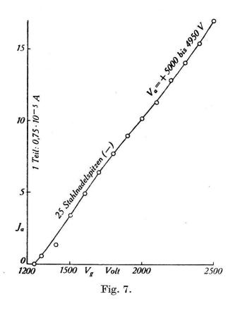
Bemerkung. Zur Aufnahme der Kennlinien wurde oben eine zweite Spannungsquelle verwendet. Es lässt sich prinzipiell auch ohne diese auskommen. Da  $V_g$  vom selben Vorzeichen wie  $V_a$  und kleiner ist, kann es durch eine Potentiometeranordnung aus der Spannungsquelle für  $V_a$  abgegriffen werden.
