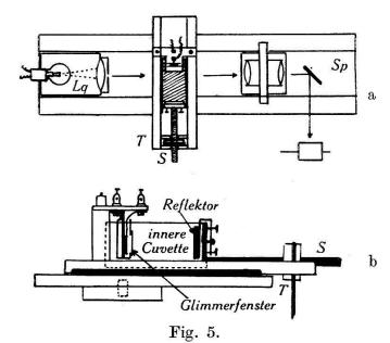
a) Optische Bank. b) Verschiebbares Versuchsgefäss.
