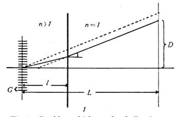
Fig. 1. Strahlverschiebung durch Brechung.
