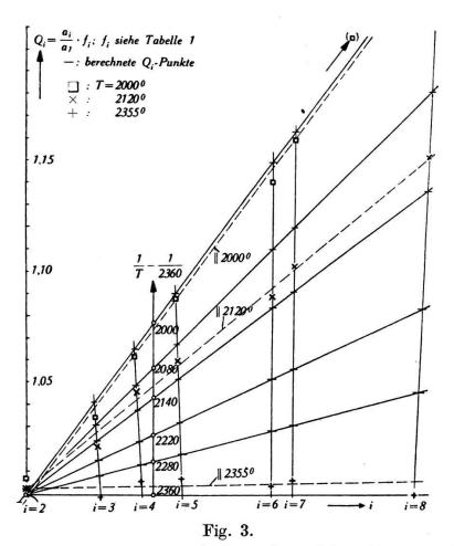
Abs. Farbtemperaturmessung mit Thermosäule und Kombinationsfilter KFIV.
