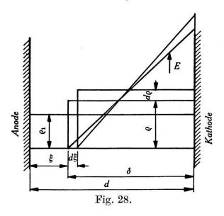
Zweiter Zeitabschnitt. Der zweite Zeitabschnitt des Aufbauvorganges wird durch Fig. 28 veranschaulicht. Wenn das Feld sich um  $\xi$  auf die Ausdehnung  $\delta$  zusammengezogen hat, muss entsprechend Gleichung (13) zwischen  $\varrho$ ,  $\delta$  und U der Zusammenhang
