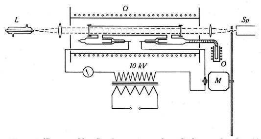
$L = ext{Wasserstofflampe} \quad M = ext{Synchronmotor} \quad Sp = ext{Spektrograph} \quad O = ext{Ofen}$  Fig. 1.
