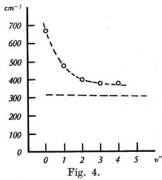
Konvergenz der Differenzen der Absorptionsmaxima von AlJ. Die Gerade gibt die Grösse der Grundschwingungsquanten  $\omega_v$ " von AlJ.
