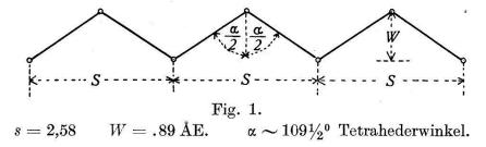
substituierter Verbindungen bestätigt worden, und zwar zeigt es sich, dass die Kohlenstoffzentren einer solchen Kette in einer Ebene, und in dieser in gleichen Intervallen auf zwei parallelen Geraden liegen, und zwar so, wie in beiliegender Figur angedeutet.
