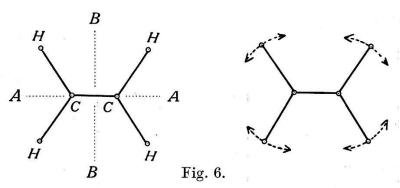
Durch Substitution zweier an ein Kohlenstoffatom gebundener Wasserstoffatome durch Sauerstoff (Ketonsauerstoff) erhält das elektrisch neutrale Kettenmolekül  $C_nH_{2n+2}$  einen Dipol. Dieser Dipol ist relativ zu der Kohlenstoffkette nur wenig beweglich und kann deshalb als Indikator für die Beweglichkeit des ganzen Moleküls benutzt werden. Die Messung der Dielektrizitätskonstanten in Abhängigkeit von der Temperatur gibt hierüber Aufschluss.
