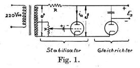
Sobald die Steuerspannung der Triode positiv wird, setzt der Anodenstrom ein, es entsteht ein Spannungsabfall am Widerstand R. Weil das Gitter mit steigender Transformatorspannung  $e_0$
