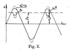
Es entstehen Spannungsspitzen konstanter Höhe  $E_s$  auf die der Kondensator über die Ventilröhre aufgeladen wird. Diese stabilisierte Gleichspannung lässt sich mit Hilfe des Potentiometers P ändern.
