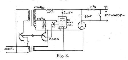
Schwankt die Netzspannung um 10%, so ändert sich die stabilisierte Gleichspannung nur um ca. 4%<sub>00</sub>.
