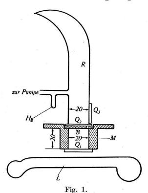
Konstruktion und Montierung der Hg-Resonanzlampe.
