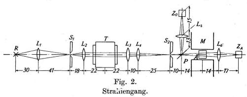
wird hierauf durch das Linsensystem  $L_3$ ,  $L_4$  auf dem Spalt  $S_2$ , der in der Brennebene dieses Systems liegt, vereinigt. In dieser Brennebene liegen auch die Beugungsspektren, die durch die Ultraschallwellen erzeugt werden, und zwar vertikal übereinander, weil auch die Schallwellen, wie unten noch beschrieben werden wird,
