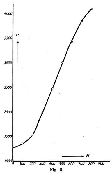
Durchlässigkeit als Funktion des Magnetfeldes für die 0-te Ordnung.
