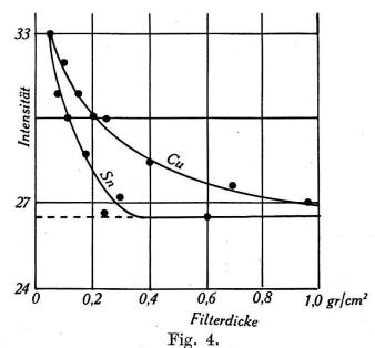
Absorptionskurven der nach Abzug der L-Strahlung übrigbleibenden Gammastrahlung.
