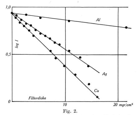
Absorptionskurven der L-Strahlung des RaD in logarithmischer Darstellung.
