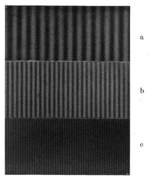
Fig. 1. Interferenzen bei Überlagerung der (a) ersten, (b) zweiten und (c) vierten Ordnungen.
