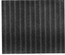
Fig. 4. Interferenzen bei Überlagerung der Ordnungen +3, +1 und -1.
