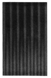
Fig. 5. Abbildung eines Schallgitters, dessen Intensität räumlich nicht konstant ist (Überlagerung aller Beugungsspektren).
