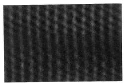
Fig. 7. Schallgitter mit gestörter Ausbildung der ebenen Wellen.
