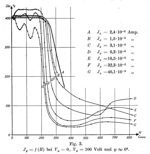
zu verstehen ist, vom Auftreten eines schwachen Anodenstromes begleitet sind. Das übrige Gebiet der  $J_g = f(H)$ -Kurve bis zum Steilabfall bei  $H = H_k$  ist dagegen vollkommen schwingungsfrei, womit feststeht, dass der eigenartige Kurvenverlauf auch nicht durch Schwingungen verursacht ist.
