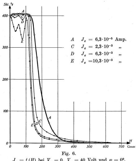
$J_g = f(H)$  bei  $V_a = 0$ ,  $V_g = 40$  Volt und  $\varphi = 0^{\circ}$ .
