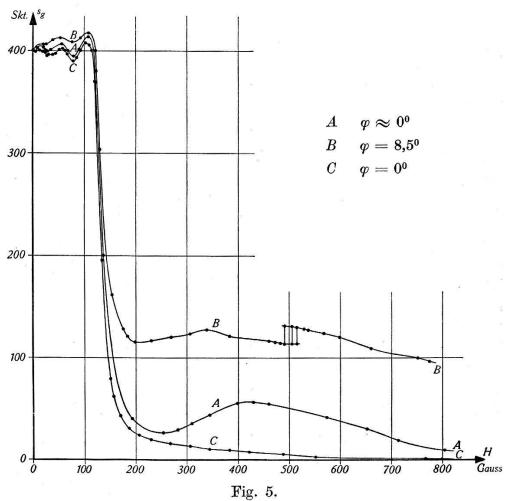
$J_g=f\left(H\right)$  bei  $V_a=0,~V_g=40$  Volt und  $J_e=6{,}3\cdot10^{-3}$  Amp. abhängig von der Justierung.
