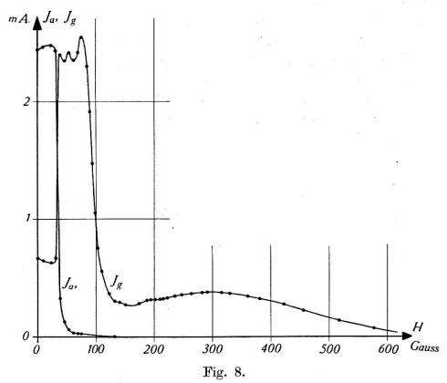
$J_a=f\left(H\right)$  und  $J_g=f\left(H\right)$  bei  $V_a=V_g=20$  Volt und  $\varphi\approx 0^{\rm o}.$
