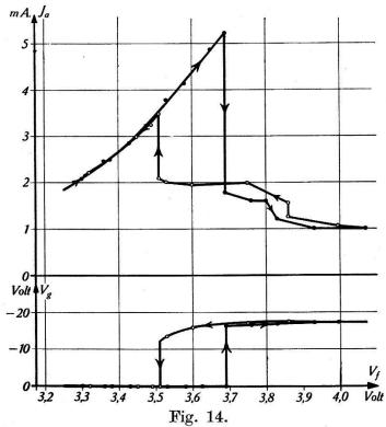
$J_{a}=f\left(V_{\mathit{f}}\right)$  und  $V_{\mathit{g}}=f\left(V_{\mathit{f}}\right)$  bei  $V_{a}=200$  Volt und isoliertem Gitter.
