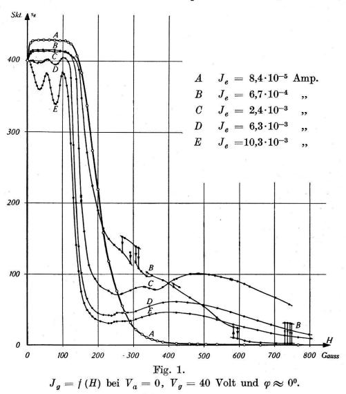
nun einfach der Gitterstrom  $J_g$  in Abhängigkeit von der Magnetfeldstärke H gemessen. Eine ganze Schar solcher  $J_g = f(H)$  darstellender Kurven wurde sodann dadurch erhalten, dass Messreihen bei verschiedenen konstanten Heizenergien im Glühfaden, also bei verschiedener Emission  $J_e$  durchgeführt wurden.
