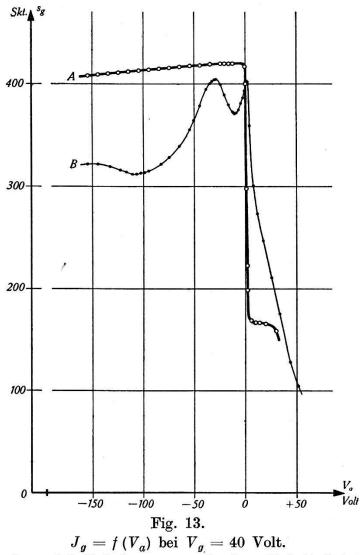
$J_{\it g}=\it f(V_a)$  bei  $V_{\it g}=40$  Volt.  $A J_e = 6.6 \cdot 10^{-5} \text{ Amp.}$  $B \quad J_e = 10.6 \cdot 10^{-3} \text{ Amp.}$
