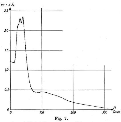
$J_g = f(H)$  bei  $V_a = V_g = 6.0$  Volt und  $\varphi \approx 0^{\circ}$ .
