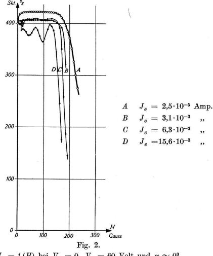
$J_g=f\left(H\right)$  bei  $V_a=0,~V_g=60$  Volt und  $\varphi\approx 0^{\circ}.$
