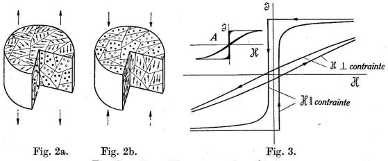
Fig. 2a. Type Ni sous traction élastique. Fig. 2b. id-sous compression élastique.
