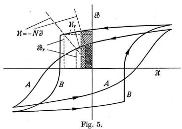
A: matière isotrope par compensation. B: matière à anisotropie texturale apolaire ( $\mathcal{H}\parallel$  dir. d'isotropie).
