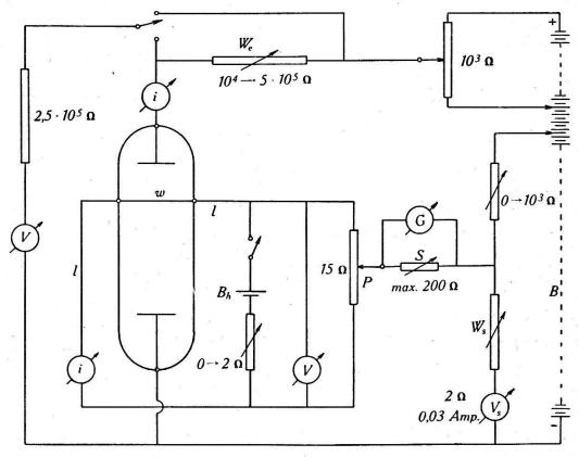
Fig. 3. Messanordnung. i = Amperemeter; V = Voltmeter.
