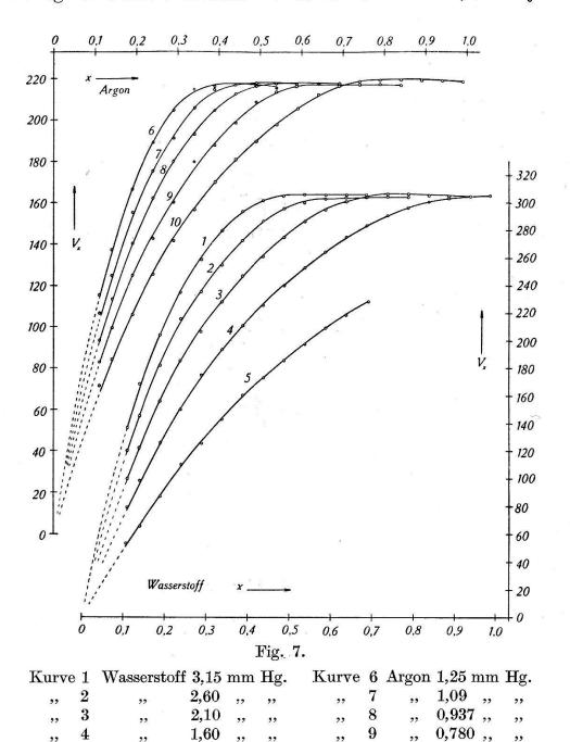
falls ein derartiger Fehler nicht vom Verhältnis der Sondendimension zur Grösse der freien Weglängen der Ladungsträger abhängen, da sonst die Potentialkurven der bei den verschiedenen Drucken aufgenommenen Messreihen in der Darstellung von Fig. 8 deutlich auseinanderlaufen müssten. Da auch die normale Stromdichte
