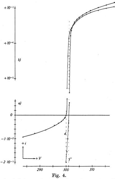
Sondencharakteristik im anodenseitigen Saum des negativen Glimmlichtes.
