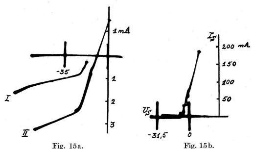
Sondencharakteristiken einer Natrium-Kleinlampe. Wolframsonde 0,125 mm Durchmesser.
