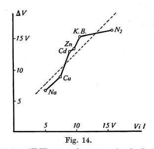
Vergleich der ermittelten  $\Delta V$ -Werte mit den entsprechenden Ionisationspotentialen.
