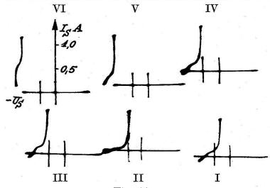
Fig. 11a. Homogenkohle-Bogen.
