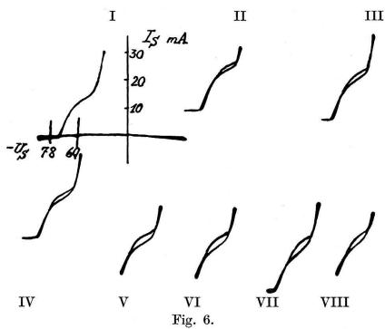
Abhängigkeit der Schleifenbreite von der Frequenz.
