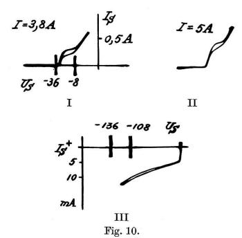
Sondencharakteristiken eines Homogen-Kohlebogens. Offener Kohlebogen, Bogenlänge l=15 mm, Anode oben, Homogenkohlen Abstand Sonde-Kathode  $\varDelta$   $l^-=12$  mm, 1,6 mm Kohlesonde.
