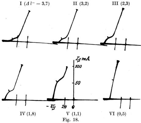
6 bei versch. Abstand Sonde-Kathode ( $\varDelta\,l^-$ ) gemessene Sondencharakteristiken. p=58 mm, l=4.0 mm, Halbkugelelektroden, Anode oben I=0.2 A, Eichmarken  $U_S=0$  und -24 V.
