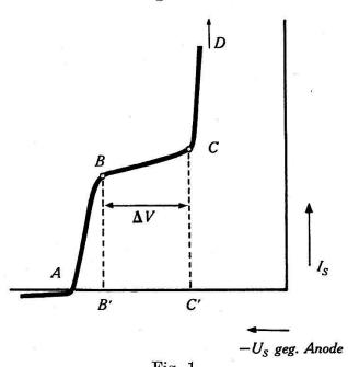
Fig. 1. Schematische Darstellung einer ( $J_S,\ U_S$ )-Charakteristik (Haupt-Typus).
