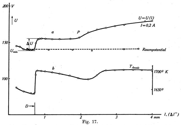
Bogenlänge-Spannungskurve, Potentialverlauf bei mittlerer Bogenlänge und Anodentemperaturkurve.
