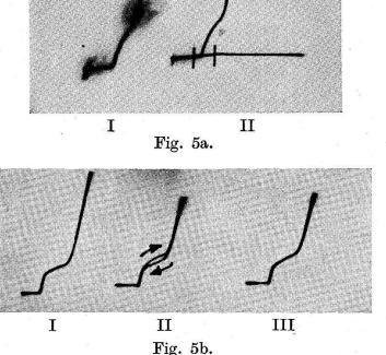
Fig. 5. a, b mittelst Braun'scher Röhre aufgenommene Sondencharakteristiken. Wolfram-Stickstoffbogen. (Druck p=125 mm Hg).
