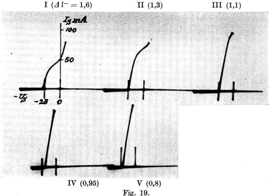
Sondencharakteristiken eines kurzen Wolfram-Stickstoffbogens. p=58 mm Hg, l=1.9 mm, Halbkugelelektroden, Anode oben, I=0.2 A.
