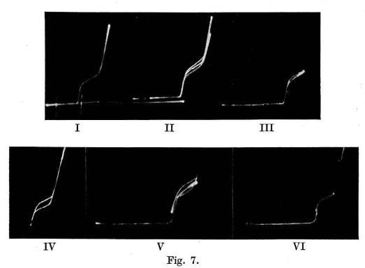
Abhängigkeit der Form der Sondencharakteristik von der Ruhespannung.  $p=125 \text{ mm Hg}, \ l=5 \text{ mm}, \ \Delta l=1,5 \text{ mm}, \ d=1 \text{ mm}$  (Bezeichnungen vgl. Fig. 6). Charakteristik I: n = 50 Hz (Eichmarken  $U_S = -80, -60$  V geg. Anode)
