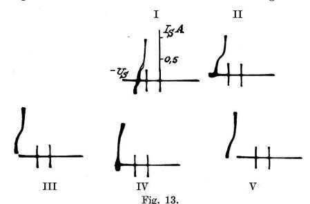
Beeinflussung des Wertes  $\varDelta V$  durch Verdampfen konzentrierter Salzlösungen. Bogenlänge l=11 mm, Anode oben, Abstand Sonde-Kathode  $\varDelta \ l^-=2,8$  mm. Eichmarken  $U_S=0$  und -27 V.
