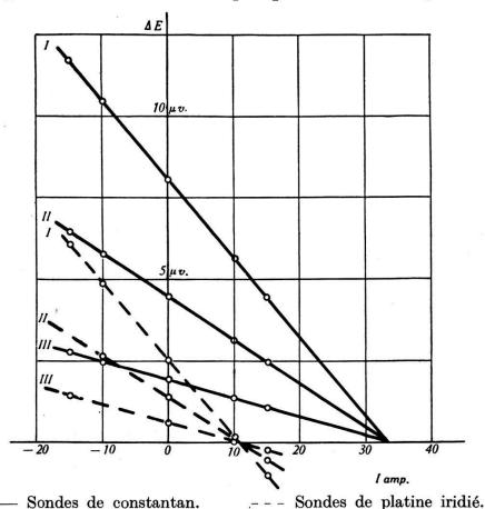
I  $\mathcal{H}=9000$  gauss II  $\mathcal{H}=4100$  gauss III  $\mathcal{H}=1750$  gauss Différences de potentiel transversales (les quatre effets transversaux superposés).  $t=58^{\circ}$ .
